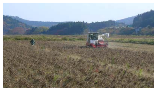
大豆 小畝立て播種自前の土寄せ板を培土板に装着、ロータリの爪配列など独自に工夫
